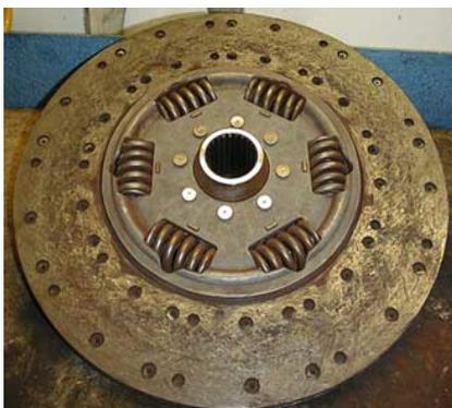
Kesalahan aplikasi operasional pada gearbox yang tidak sesuai untuk unit yang menggunakan I-shift gearbox dapat menyebabkan cepatnya tingkat keausan pada kampas kopling-nya, seperti menahan atau melakukan pengereman dengan menggunakan engine bukan menggunakan rem pada posisi tanjakan Hal tersebut akan mengakibatkan overheating pada permukaan kampas kopling dan kampas kopling akan lebih cepat mengalami keausan.
